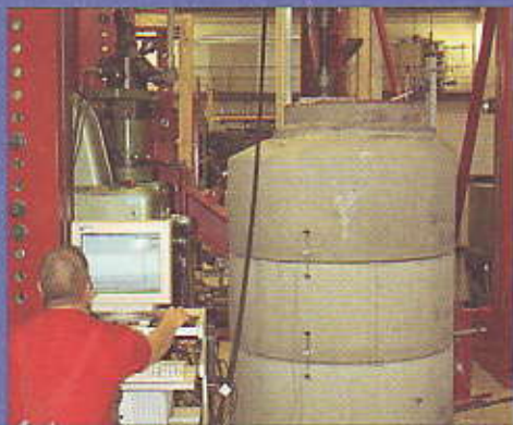
Die dynamische Prüfung mit 4 Millionen Lastwechsel
